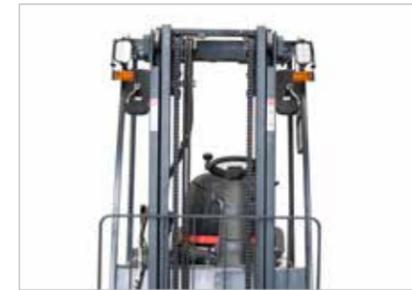
Las mangueras hidráulicas ordenadamente dispuestas ofrecen una clara visibilidad delantera a través del mástil de amplia visibilidad.
