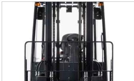
Las mangueras hidráulicas ordenadamente dispuestas ofrecen una clara visibilidad delantera a través del mástil de amplia visibilidad.
